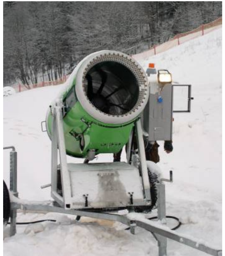
Solch eine Schneekanone schafft es, 25m 3 Wasser pro Stunde in Schnee zu verwandeln
